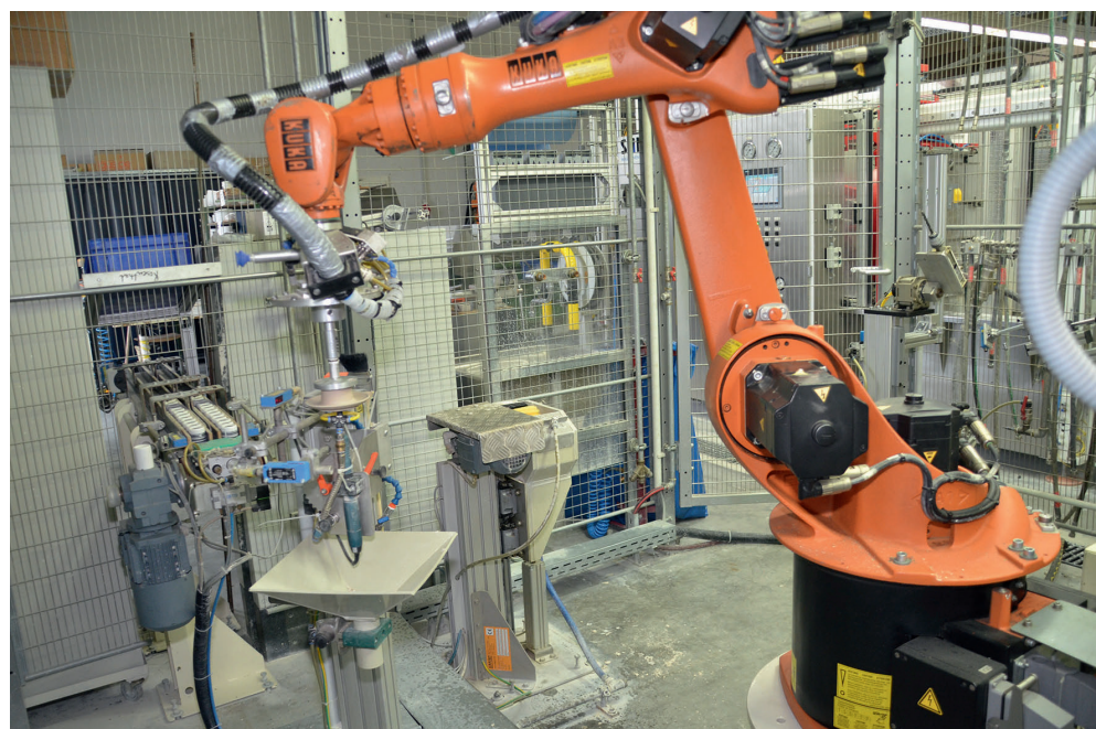
6 Bei der Endbearbeitung der Porzellan-Rohteile in der Roboterzelle senkte der QCH den Rüstzeitaufwand erheblich, entfiel doch das häufige Nachteachen des Roboters aufgrund von Maßabweichungen beim nachgeschliffenen Standardwerkzeug © Hanser
