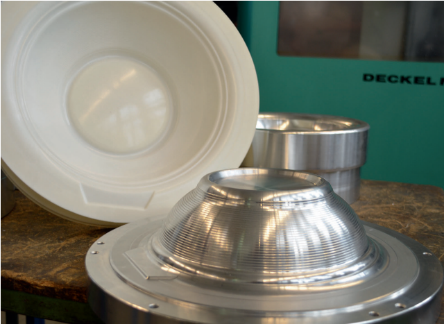
4 Auch diese Alu-Arbeitsformen für das isostatische Pressen von Schüsseln werden jetzt mit dem QCH von ZCC Cutting Tools gefräst. Nur die PUR-Membran (links) und ein PUR-Beschichtungselement berühren beim Pressen das Rohgranulat ©Hanser
